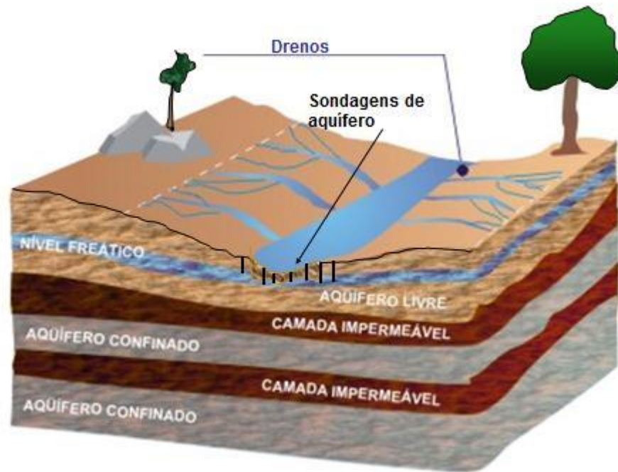
Figura 5. Esquema de laudo técnico hidrogeológico para averiguação de lençol freático quando o dreno estiver na situação de ausência fluxo de hídrico superficial.
