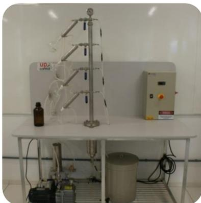
**Figura 15.7.** Coluna de destilação piloto, com capacidade para 2 L de óleo essencial bruto. (Fonte: próprios autores).
