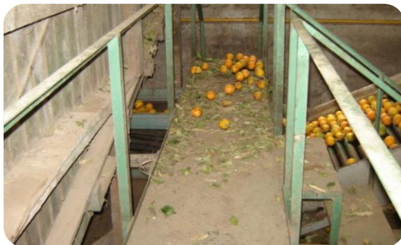
**Figura 14.5.** Imagem de máquina embaladora com restos de frutos e folhas advindos do material colhido que compelem para limpezas periódicas das estruturas na casa de embalagem. (Foto: Renar J. Bender).
