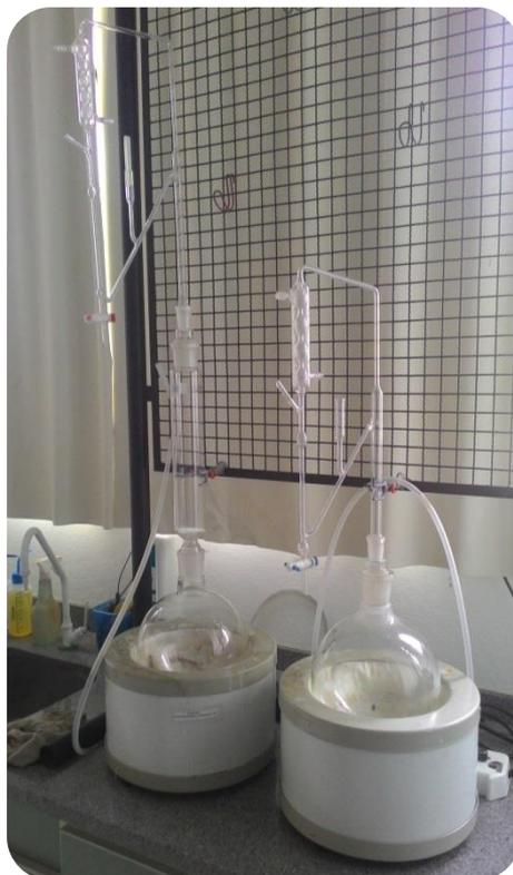
**Figura 15.4.** Montagem de sistemas de bancada (até 500 g de amostra seca) de arraste a vapor d'água (esquerda) e de hidrodestilação (direita).
