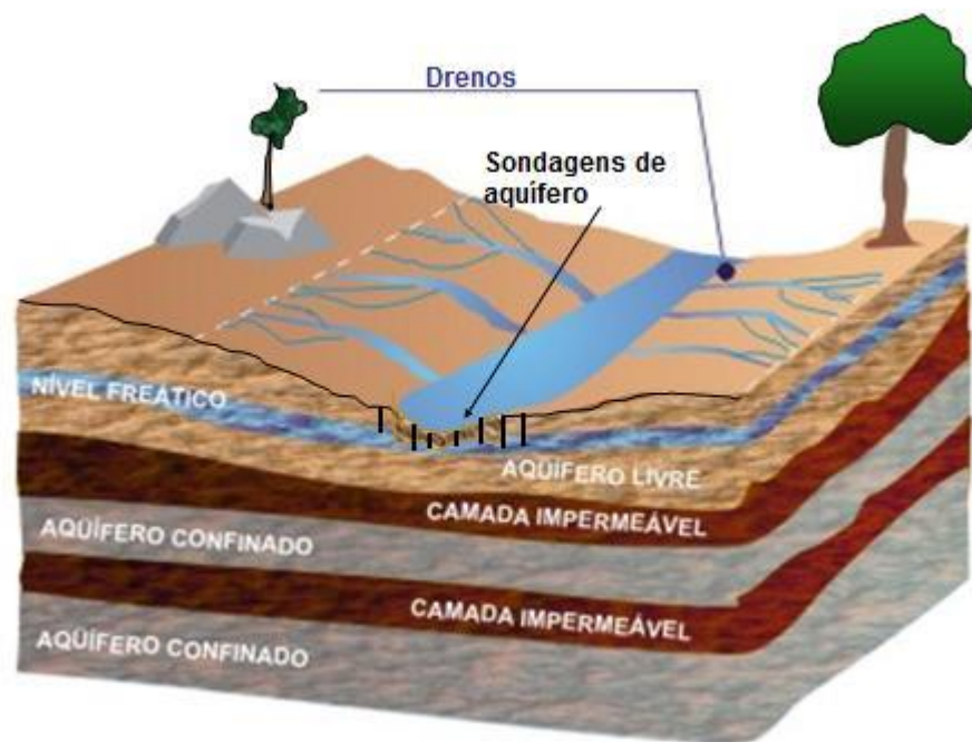
Figura 5. Esquema de laudo técnico hidrogeológico para averiguação de lençol freático quando o dreno estiver na situação de ausência de fluxo de hídrico superficial.
