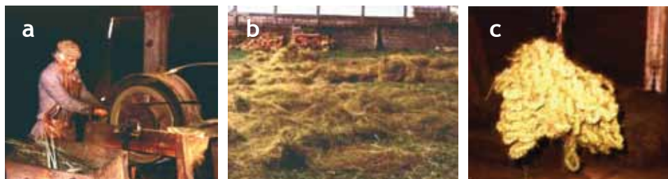
Figura 1- Processo de extração da fibra da folha do butiazeiro: (a) desfiamento da folha; (b) fibras secando; (c) fibra trançada.
