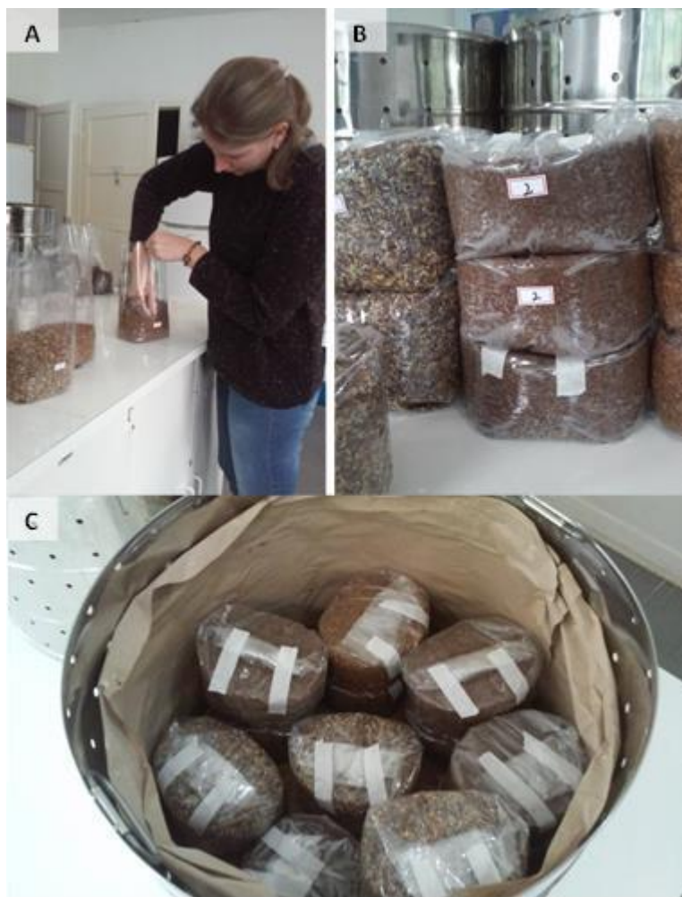
Figura 8. Preenchimento das unidades de produção com o substrato (A), detalhe do fechamento individual (B) e distribuição no cesto metálico para realização do processo de esterilização com calor (C). Fonte: Gerusa Pauli Kist Steffen (A, B, C).
