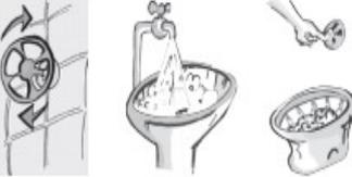
**2. Quando a caixa estiver quase vazia, feche a saída e utilize a água que restou para a limpeza da caixa e para que a sujeira não desça pelo cano.**
