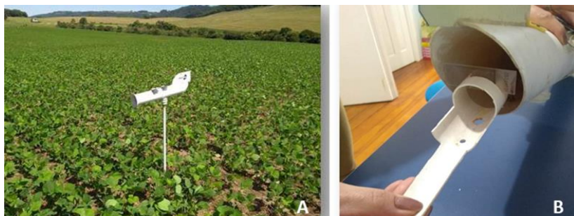
Figura 5. Modelo de coletor de esporos (A) com lâminas adesivadas acopladas (B) utilizado no monitoramento de uredósporos de P. pachyrhizi .
