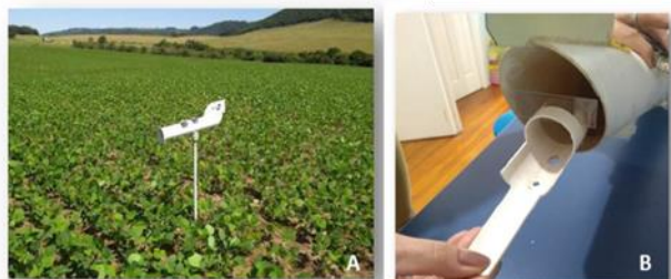
Figura 2. Modelo de coletor de esporos utilizado no monitoramento de P. pachyrhizi . Fonte: Emater/RS-Ascar
