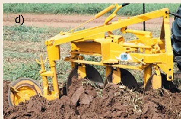
Figura 4. Equipamentos de preparo primário e periódico do solo. Escarificadores (a), Grades niveladoras (b), grades aradoras (c) e arado de discos reversível (d).
