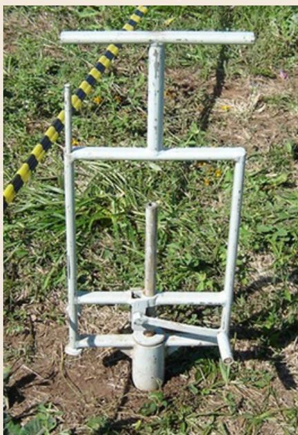
Figura 2. Trado para coleta de amostras de solo com estrutura preservada, utilizadas para determinações da densidade, porosidade, grau de saturação entre outros mais.
