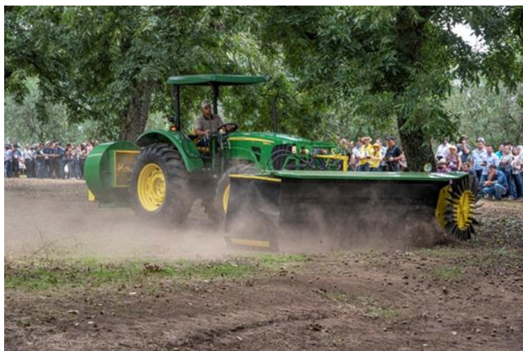
Figura 9. Recolhimento de nozes com trator equipado com vassouras na dianteira e sopradores na traseira.
