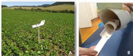
Figura 2. Modelo de coletor de esporos utilizado no monitoramento de P. pachyrhizi .
